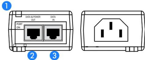
1 LED für die Spannungsversorgung und den Zustand der LAN-Verbindung
